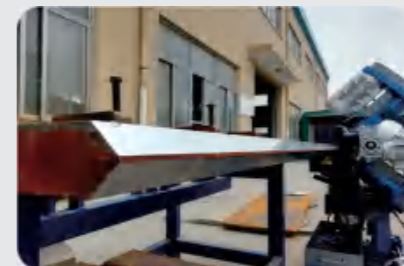
加工K型坡口 Processing "K" of bevel type
