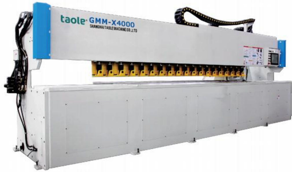
高效坡口作业 0~1200mm/min PROCESSING SPEED
