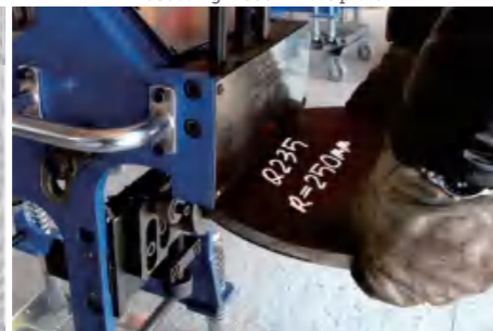
加工Φ500mm圆弧板 Processing Φ500mm arc plate
