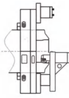
E 内复合坡口加工 E Counter Boring
