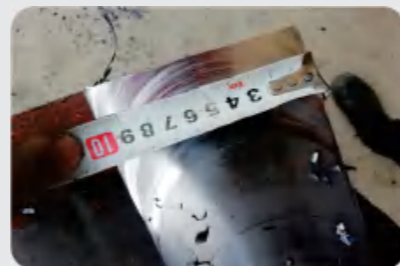
加工过渡坡口 Processing bevel 100mm
